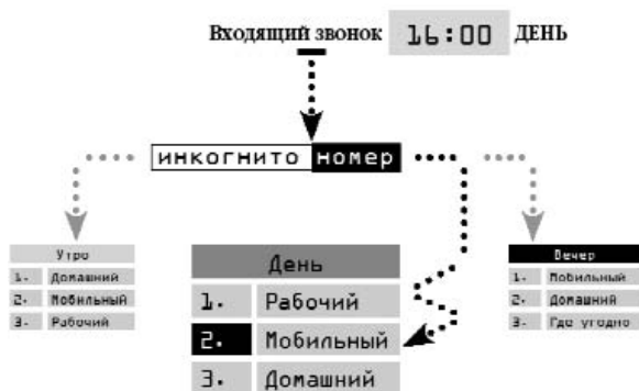
Рис. 1. Схема переадресации входящего вызова
